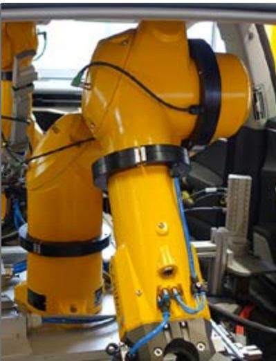
Roboterheizung / Robot heating
