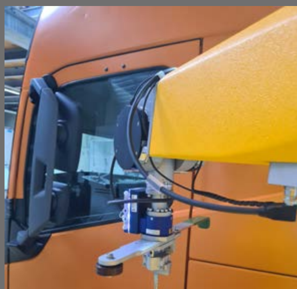
Tür- und Klappentest bei LKW / Door and flap testing for trucks
