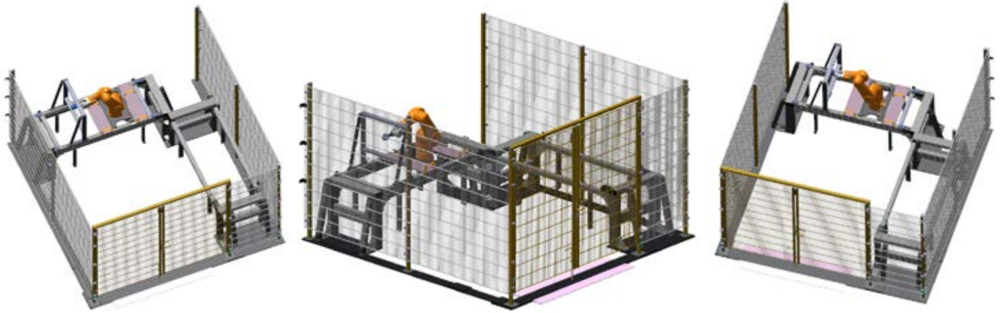
Sicherheitszaun / Safety fence
